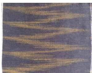
图5 断纬实际织造织物照片
