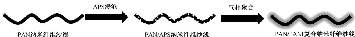
图 1 PAN/PANI 复合纳米纤维纱线制备流程图
