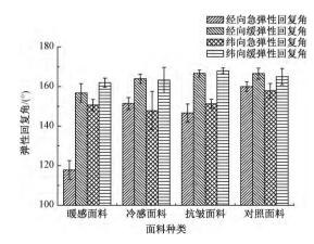
图 1 面料弹性回复角
