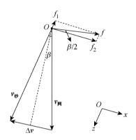
图 4 集聚区纤维受到的摩擦力分解示意图
