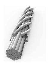
图 2 集聚区须条皮芯结构示意图
